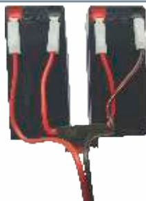
Akumulatory zasilania zewnętrznego DUMPER
